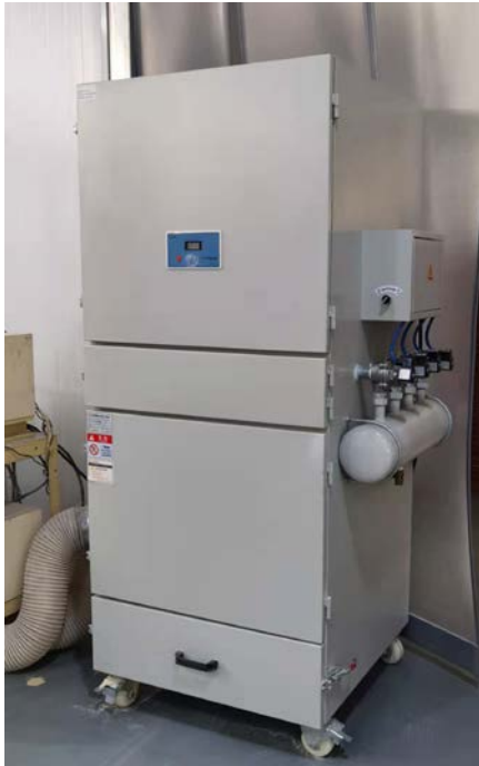
图 4-1 脉冲滤筒除尘器
